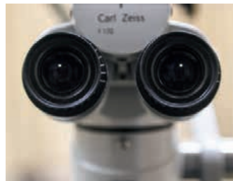
Стоматологический микроскоп дает 3,5–21-кратное увеличение
